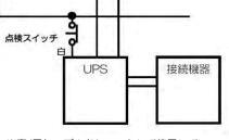
商用電源 壁スイッチ等 点検スイッチ **UPS** 接続機器
